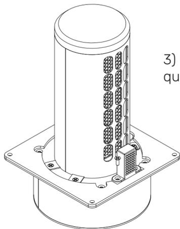
4) Tirez sur le câble du capteur et retirez le connecteur.
