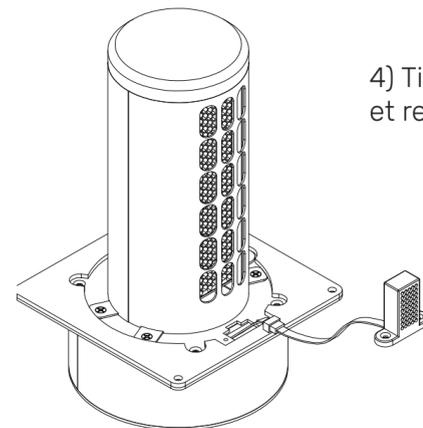
5) Remplacez le capteur et insérez les câbles dans le Defender<sup>7</sup>.
